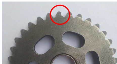
Gambar 3.4 Rusak satu buah gigi sebagian ( \frac{1}{2} diameter 1,5mm)
