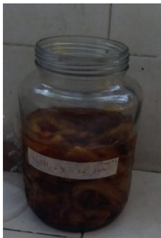
Gambar 3.11. Proses alkalisasi serat abaca
