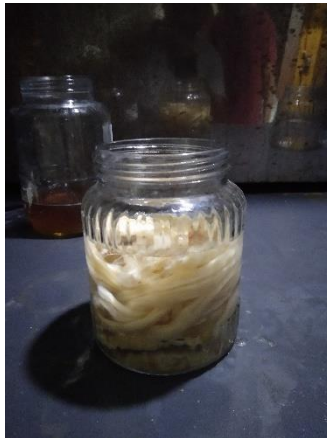
Gambar 3.15. Proses perendaman serat abaca menggunakan aquades
