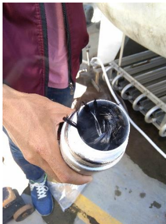
Gambar 3.20. Proses perendaman serat karbon
