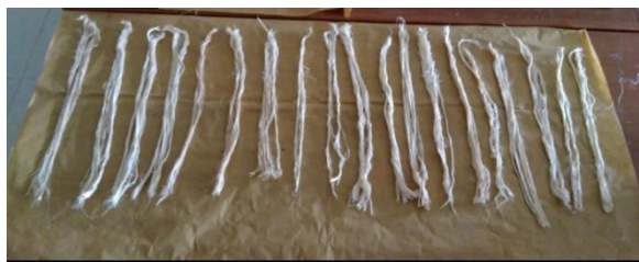
Gambar 3.16. Proses pengeringan serat abaca
