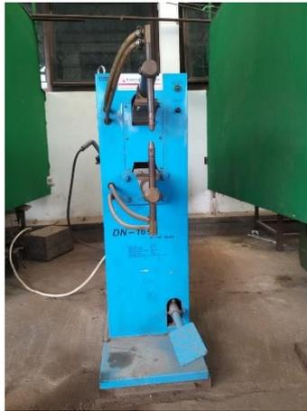
**Gambar 3.1** Mesin las titik (spot welding)
