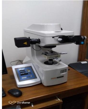
**Gambar 3.4** Alat uji kekerasan *Vickers*
