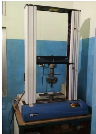
**Gambar 3.3** Alat uji tarik tipe instron 3367
