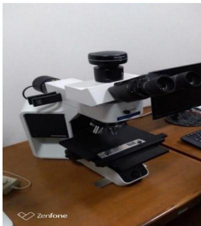
**Gambar 3.2** Alat uji struktur mikro
