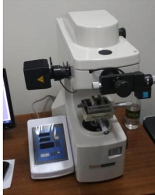
Gambar 3.4 Alat uji kekerasan vickers
