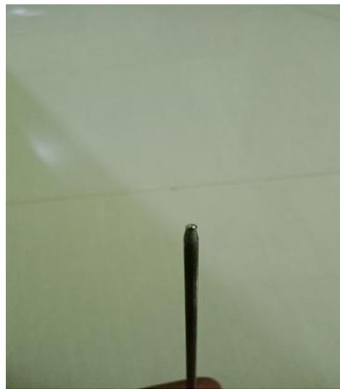
Gambar 3.11 Ujung tungsten yang dibentuk seperti bola
