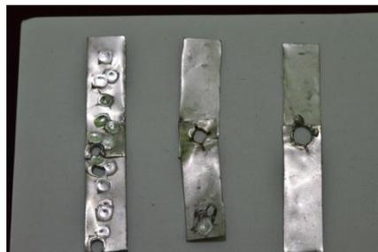
Gambar 4.4 Hasil percobaan las dengan waktu 5 detik dengan arus 120 A, 125 A, 130 A, dan 135 A
