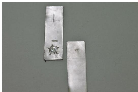
Gambar 4.1 Hasil percobaan las menggunakan arus 90 A dengan waktu 2 detik
