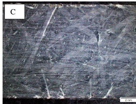
Gambar 3.6 Foto Makro Patahan Hasil Pengujian Bending Menggunakan Mikroskop Optik (A) PMMA, (B) Epoxy, (C) Polyester
