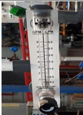
Gambar 3. 7 Rotameter Air 3 LPM
