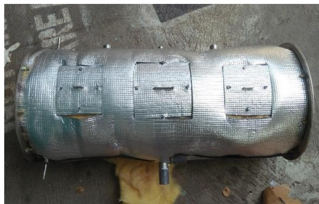
Gambar 3. 3 Tangki SWH dilapisi *glass woll* dan alumunium foil
