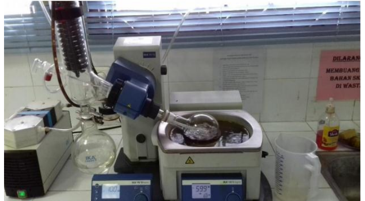
Evaporasi ekstrak lada putih ( Piper nigrum L ) dengan rotary evaporator
