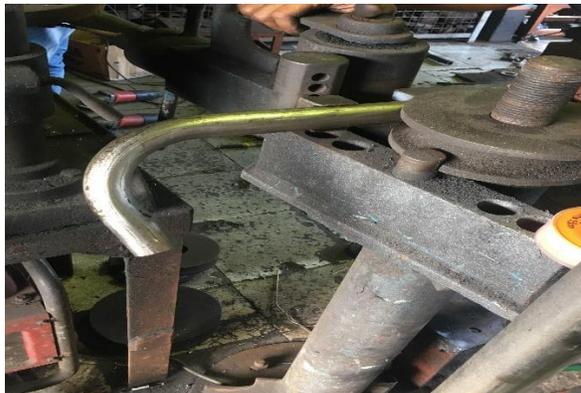
Gambar 3.14 penekukan pipa header bagian belakang
