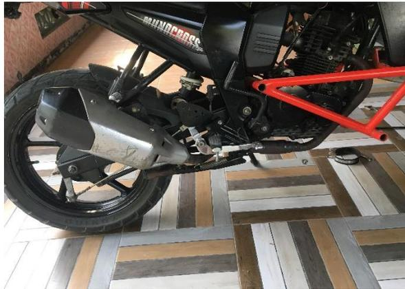
Gambar 3.16 knalpot alternatif terpasang di motor Yamaha Byson
