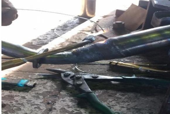
Gambar 3.13 pengelasan catalytic converter dengan header
