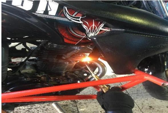
Gambar 3.11 pemanasan header dengan las asetilin
