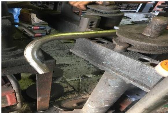
Gambar 3.10 pembentukan header dengan alat bending
