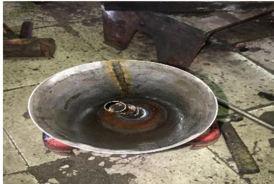
Gambar 3.6 bagian dalam silincer yang belum terdapat gasbul
