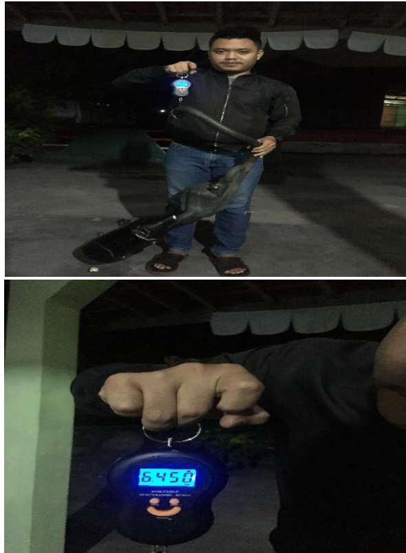
Gambar 4.4 hasil uji bobot knalpot standar
