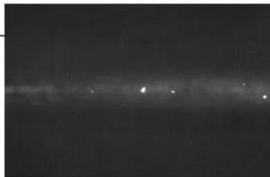
**Gambar 2.4** *Tungsten Inclusion* (pengelasan.net)
