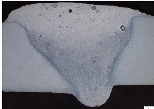
**Gambar 4.11** Hasil Uji Makro dengan Pencekam pada Kedua Sisi Spesimen Kecepatan 7 mm/s
