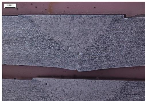
**Gambar 4.9** Hasil Uji Makro dengan Pencekam pada Satu Sisi Spesimen Kecepatan 8 mm/s
