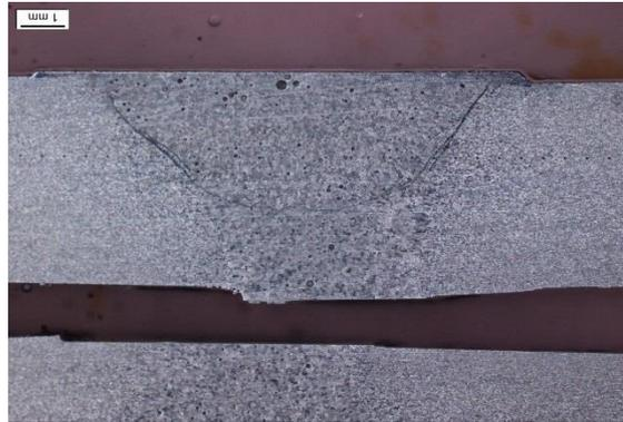
**Gambar 4.7** Hasil Uji Makro dengan Pencekam pada Satu Sisi Spesimen Kecepatan 6 mm/s
