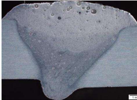
**Gambar 4.10** Hasil Uji Makro dengan Pencekam pada Kedua Sisi Spesimen Kecepatan 6 mm/s
