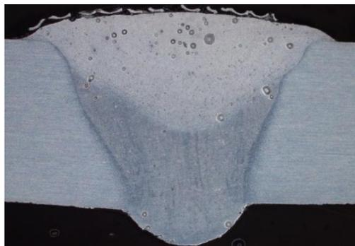
**Gambar 4.12** Hasil Uji Makro dengan Pencekam pada Kedua Sisi Spesimen Kecepatan 8 mm/s
