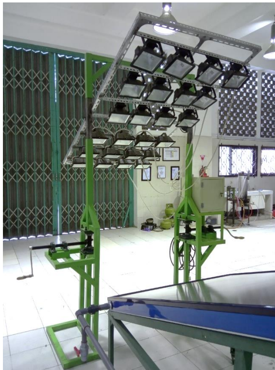
Gambar 4.15 Hasil pabrikasi solar simulator
