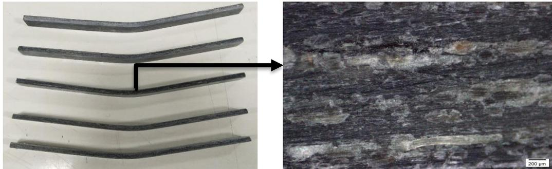
**Gambar 4.3** Hasil spesimen uji bending abaka/karbon.
