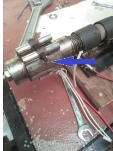
Gambar 4.23 Pemasangan Heater pada Stoper
