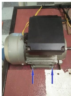
Gambar 4.11 Pemasangan Motor Listrik
