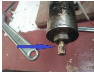
Gambar 4.22 Pemasangan dudukan nozzle
