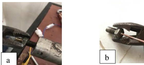
Gambar 10 (a) Pelepasan dudukan nozzle dan nozzle (b) Pembersihan sisa lelehan butiran plastik pada dudukan nozzle dan nozzle
