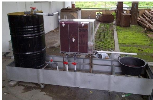
Gambar 3.11 Alat Uji Adsorpsi Limbah Cair Rumah Sakit Dengan Zeolit Dan Arang Aktif Dari Bahan Limbah Industri Mebel Kayu Jati secara Aliran Kontinu.
