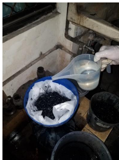
Gambar 3.21 Penyiraman Arang Dengan Aquades
