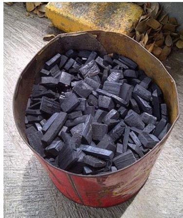
Gambar 3.16 Potongan Limbah Kayu Jati yang Sudah Menjadi Arang
