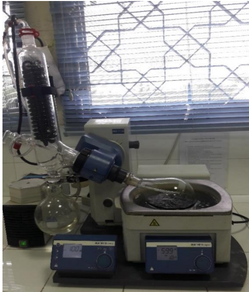
Gambar 3. Proses pengentalan ekstrak menggunakan rotary evaporator dan waterbath
