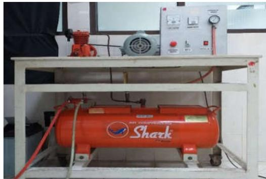
**Gambar 3.4** Kompresor udara
