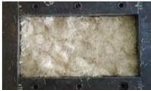
Gambar 3.27 Proses penyusunan serat kenaf
