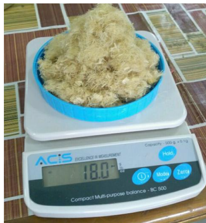
Gambar 3.26 Proses Penimbangan Serat Kenaf
