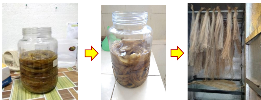
Gambar 3.23. Proses alkalisasi, dan pengeringan serat
