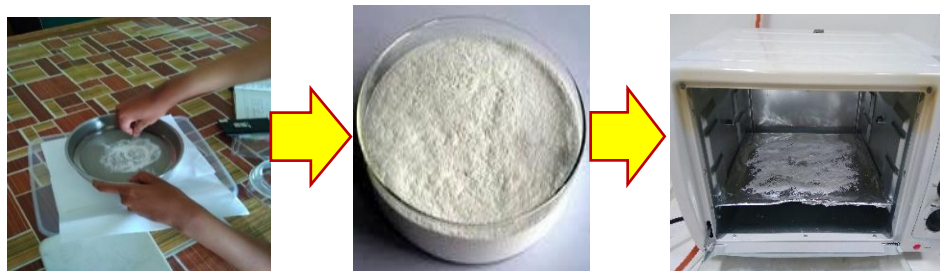
Gambar 3.25 Pengayakan Silica Fume
