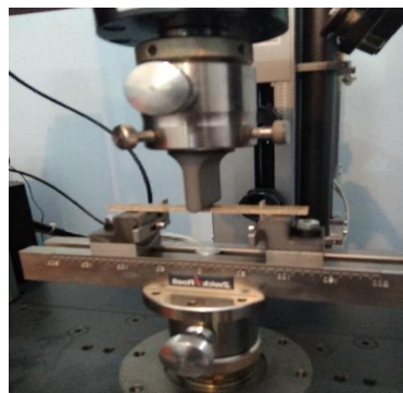
Gambar 3.34 Preoses pemasangan pada span
