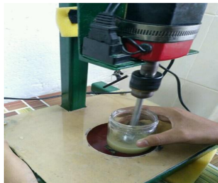
Gambar 3.28 Proses pencampuran epoxy dan silica
