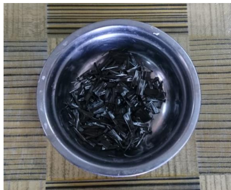
Gambar 3.13 serat karbon dipotong sesuai variasi
