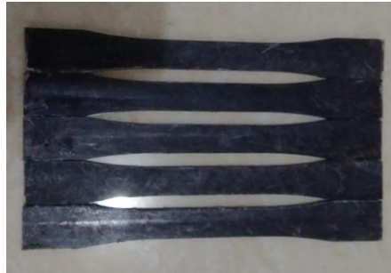
Gambar 3.25 Spesimen yang sudah dikasih label pada ujungnya.
