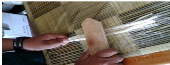
Gambar 3.16 Proses sisir serat abaka.
