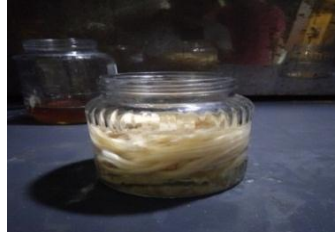
Gambar 3.14 Proses perendaman serat abaka menggunakan aquades
