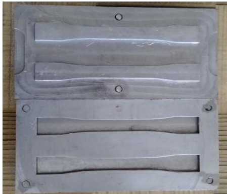
Gambar 3.2 Cetakan Pengujian Tarik ASTM D 638-01
