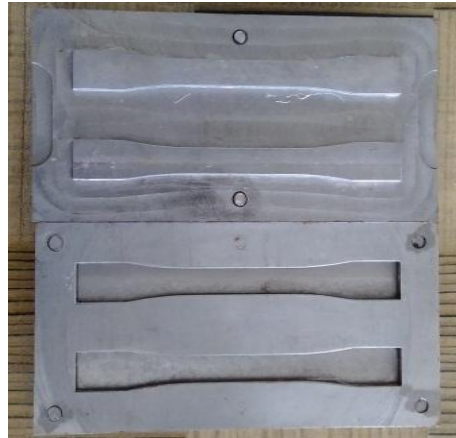
Gambar 3.24 Cetakan pengujian tarik ASTM D638-01
