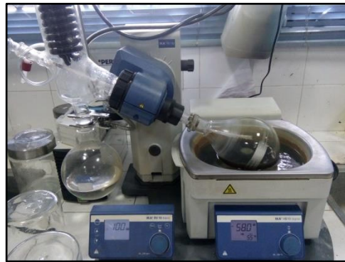
pengentalan ekstrak menggunakan rotary evaporator
