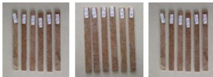
Gambar 1. Spesimen Uji Bending dan Impak Komposit
