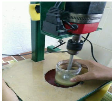
Gambar 3.36 Proses pencampuran epoxy dan silica
