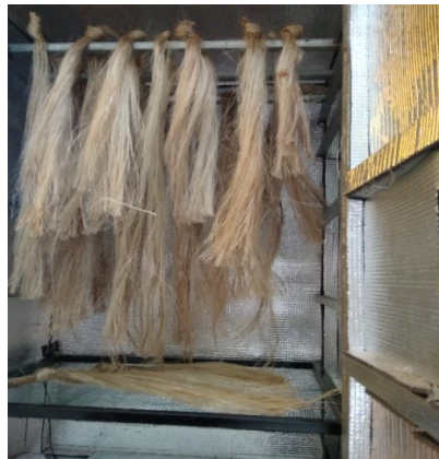
Gambar 3.20 Pengeringan Serat dengan Mesin Pengering Serat
