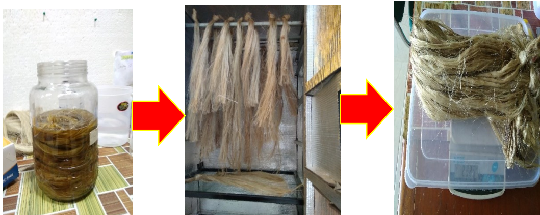
Gambar 3.21 Pencucian Serat menggunakan Aquades, Pengeringan Serat, dan Penimbangan Serat
