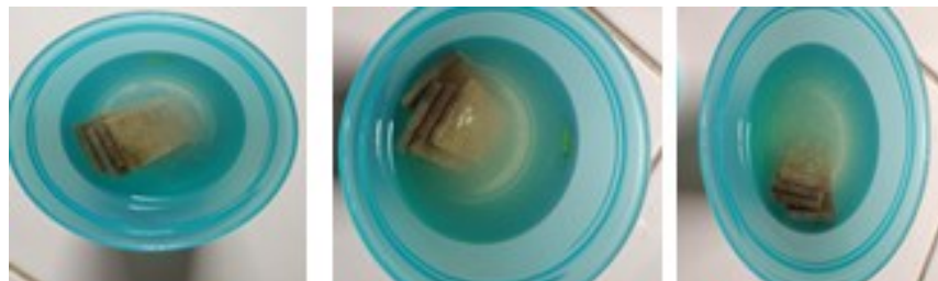
Gambar 3.39 Perendaman Spesimen Uji Daya Serap Air
