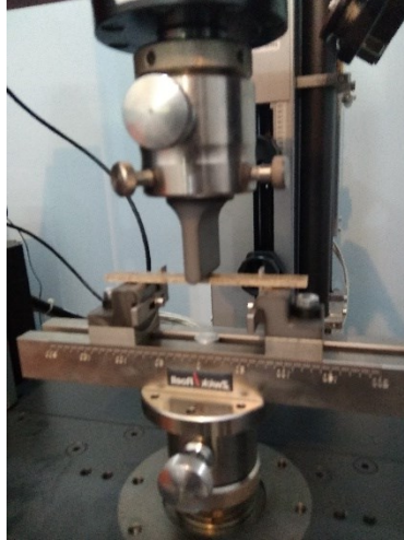
Gambar 3.32 Preoses pemasangan pada span
