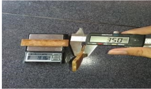
Gambar 3.40 Pengukuran Tebal dan Penimbangan Berat Spesimen setelah Perendaman
