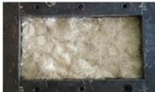
Gambar 3.26 Proses penyusunan serat kenaf
