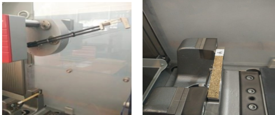
Gambar 3.36 Proses pengujian Impak
