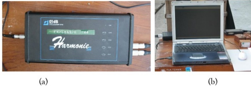
Gambar 4.10: Penganalisis Harmonie (a) yang disambungkan kepada komputer (b) untuk pengoperasian peralatan dan fungsi spektrum (Rosyidi, 2013)
