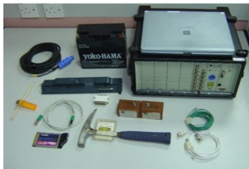
Gambar 4.10: Penganalisis Harmonie (a) yang disambungkan kepada komputer (b) untuk pengoperasian peralatan dan fungsi spektrum (Rosyidi, 2013)
