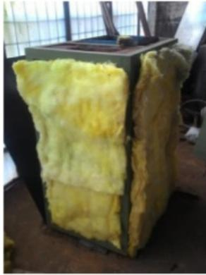
GAMBAR 4. Pemasangan isolator
