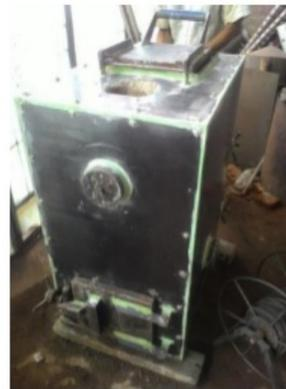
GAMBAR 8. Pendempulan incinerator
