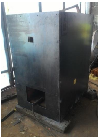
GAMBAR 5. Pemasangan casing incinerator
