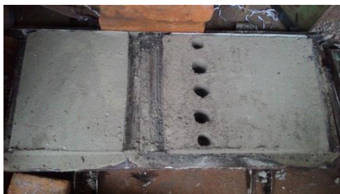
GAMBAR 6. Pengecoran castable pada pintu
