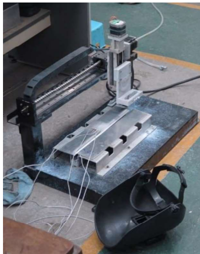
Gambar 3.5 Alat bantu las semi otomatis
