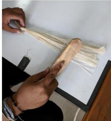
Gambar 3.16 Penyisiran serat sisal
