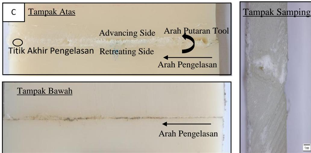
**Gambar 4.1** Hasil pengelasan dengan metode FSW menggunakan parameter variasi bentuk *pin tool* a. Silinder, b. Silinder ulir, c. Tirus ulir dengan kecepatan putar *spindle* 2350 rpm dan *feed rate* 6 mm/menit.
