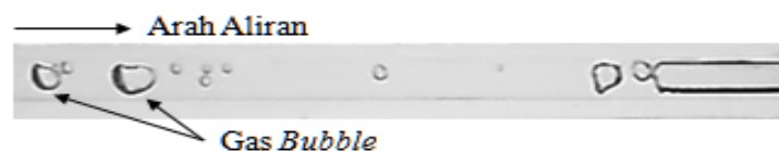
Gambar 2. Pola aliran bubbly pada J_G = 0,116 m/s, J_L = 0,879 m/s
