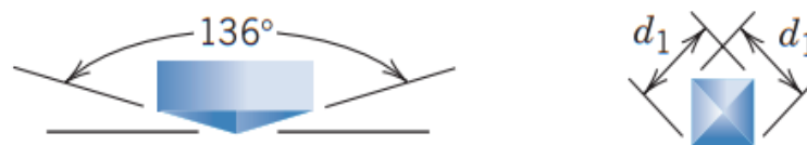
Gambar 2.7 Bentuk indenter pengujian kekerasan vickers (Callister, 2001)
