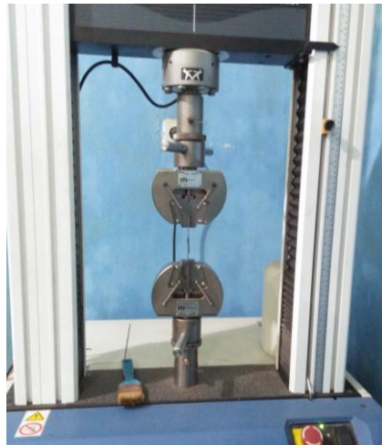
Gambar 3.22 Pemasangan specimen pada alat uji tarik
