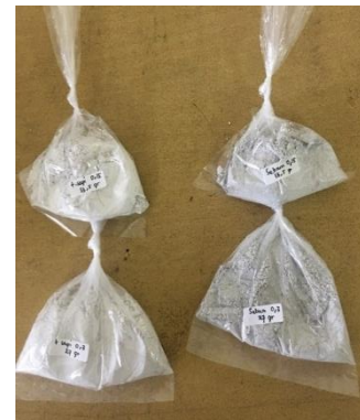
Nano abu tulang sapi dan nano abu sekam yang telah ditimbang
