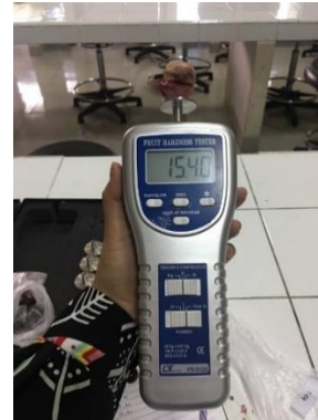
Alat hand penetrometer untuk mengukur kekerasan ubi
