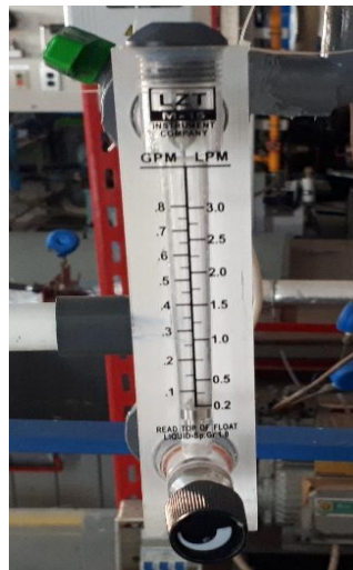
Gambar 3.4 Rotameter Air 3 LPM
