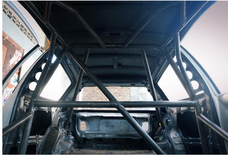
Gambar 2.13 Desain rollbar dengan triangulasi (Fastnlow.net).
