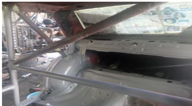
Gambar 4.11 Proses Epoxy Bagian Body Jok Belakang.
