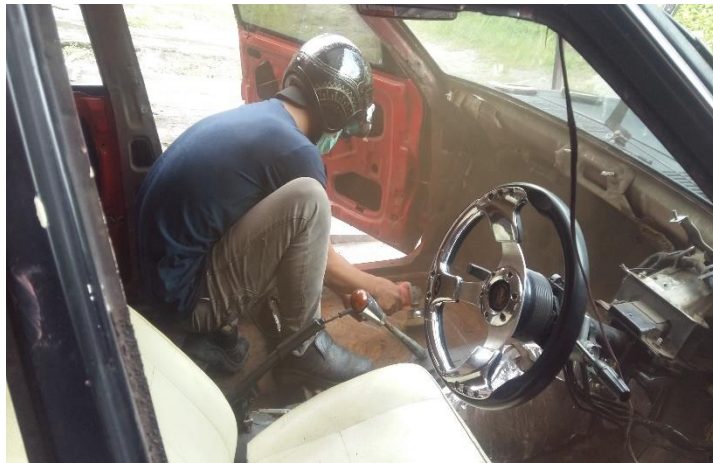
Gambar 4.3 Pembersihan chassis body
