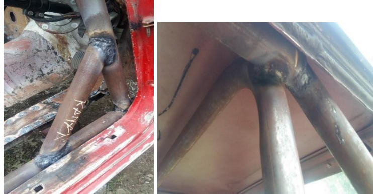
Gambar 4.9 las bagian depan dan atas
