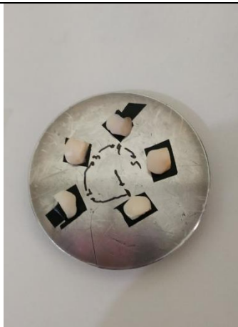
Gigi dipasang di alat untuk melakukan proses SEM
