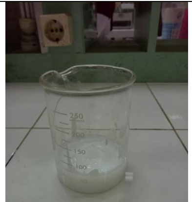
Hasil dari pengendapan sintesis hidroksi apatit
