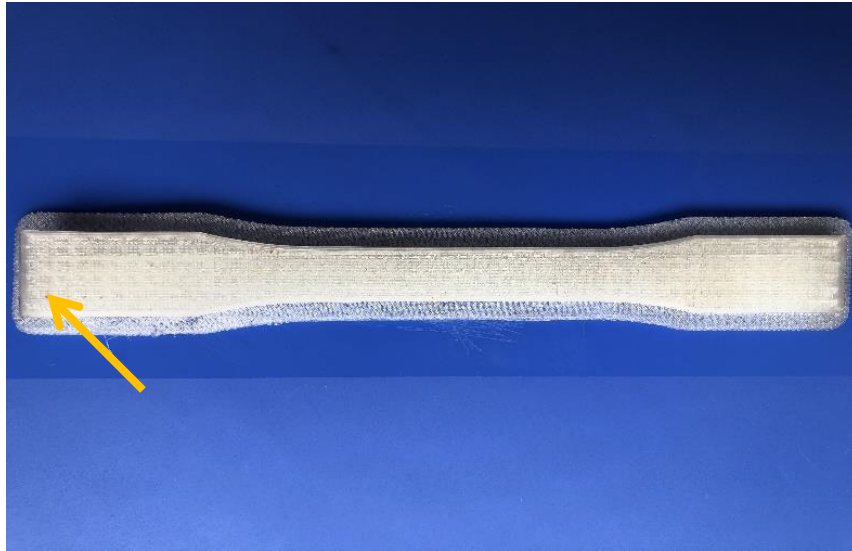
Gambar 4.1. Sampel spesimen produk 3D printing
