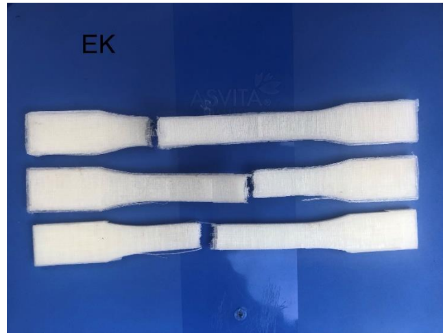
Gambar 4.20. hasil uji Tarik spesimen eksperimen konfirmasi
