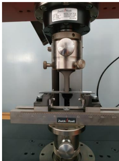
Gambar 3.13 Persiapan uji bending
