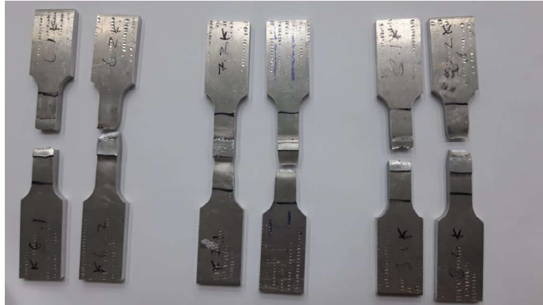
Gambar 3.18 Gambar spesimen uji tarik setelah dilakukan pengujian
