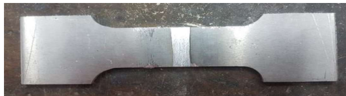
Gambar 3.17 Spesimen uji tarik sesuai standar ASTM E8
