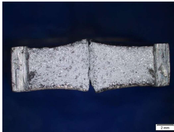
Gambar 4.18 Foto makro hasil pengujian impak kecepatan las 6 mm/s
