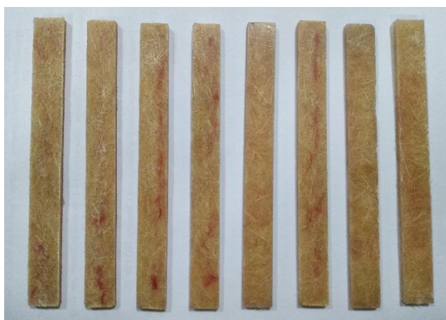
Gambar 3.16 Hasil Cetakan sesuai dengan ASTM D790-02
