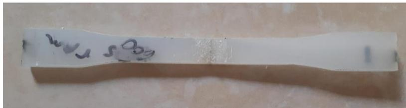
**Gambar 3. 13** Hasil potongan spesimen untuk pengujian tarik
