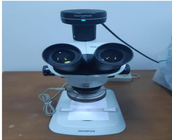
**Gambar 3. 3** Alat Uji Struktur Makro *Olympus* seri SZ61
