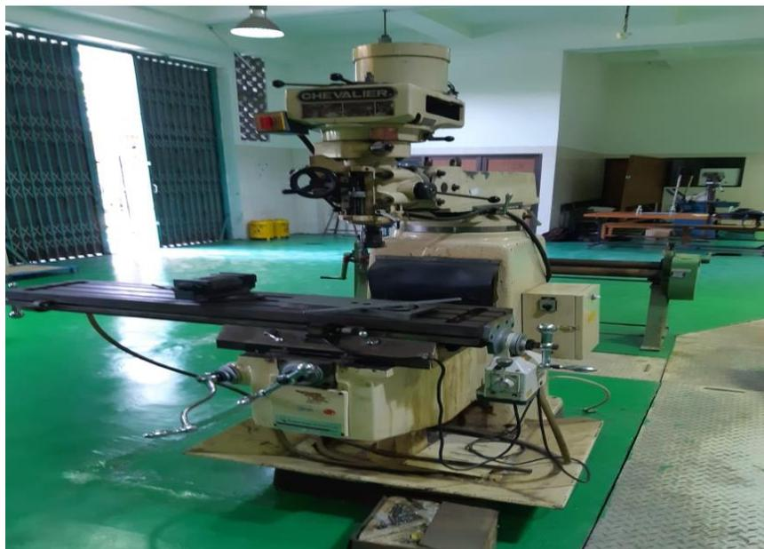
**Gambar 3. 2** Mesin *Frais Milling Vertikal FM-2SK Chevalier*
