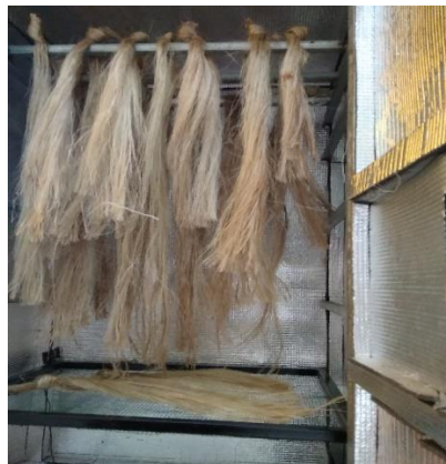
Gambar 3.10 Pengeringan Serat dengan Mesin Pengering Serat
