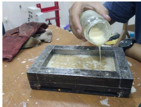
Gambar 3.18 Penuangan Matriks dan Mikrosilika
