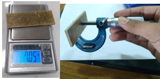
Gambar 3.29 Penimbangan dan Pengukuran Spesimen
