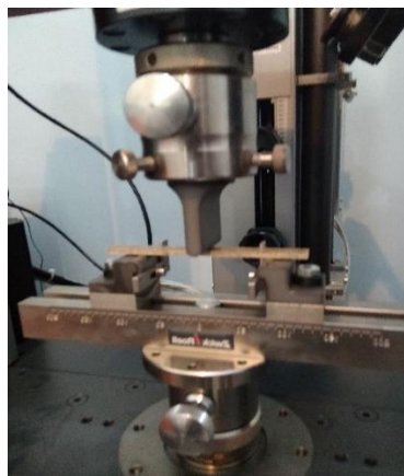
Gambar 3.23 Proses pemasangan pada span
