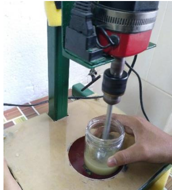
Gambar 3.17 Pencampuran Matriks dan Mikrosilika
