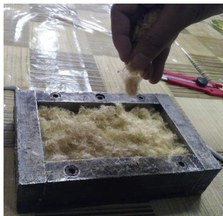
Gambar 3. 16 Penyusunan Serat Kenaf
