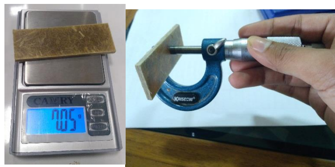
Gambar 3.29 Penimbangan dan Pengukuran Spesimen
