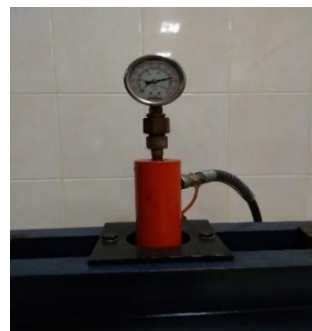
Gambar 3.19 Proses press dengan Mesin Hot Press
