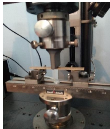
Gambar 3.23 Proses pemasangan pada span
