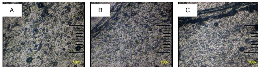
Gambar 8 Struktur mikro daerah HAZ aluminium 1xxx
