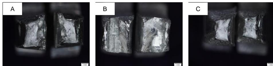
Gambar 13 Permukaan patahan uji tarik
