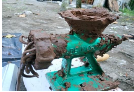
4. Pencetaan inokulum pelet dengan mencampur air pada inokulum crude kemudian dicetak.
