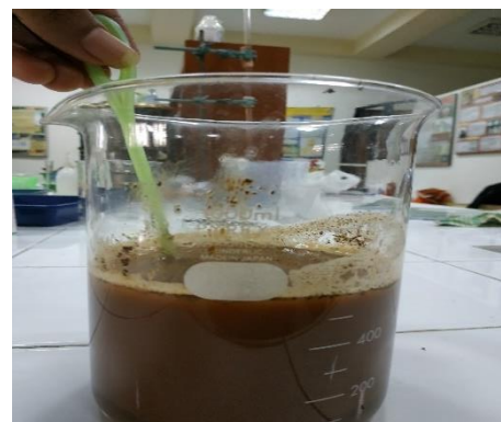
2. Pelarutan tanah menggunakan aquadest 500 ml
