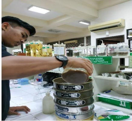
3. Penyaringan larutan tanah menggunakan alat penyaring dekantasi
