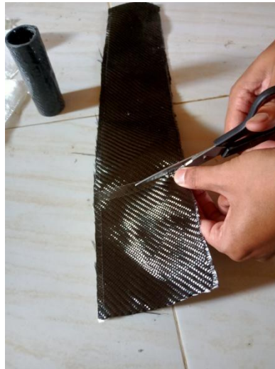
Gambar 3.15 Proses pemotongan serat carbon kevlar .
