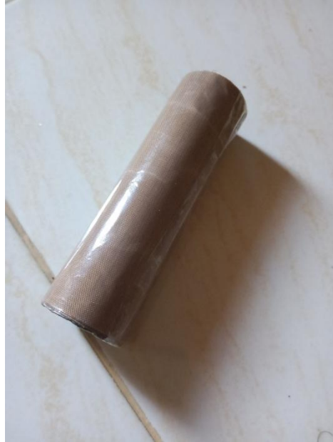
Gambar 3.17 Cetakan pipa yang dilapisi kertas teflon.
