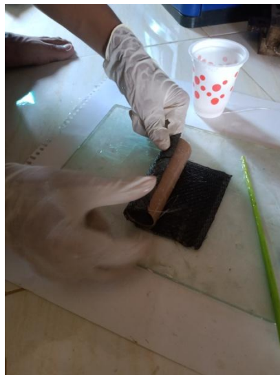
Gambar 3.18 Proses fabrikasi komposit tabung.
