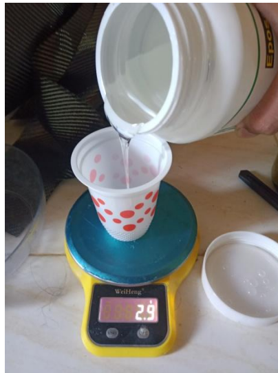
Gambar 3.16 Proses pencampuran resin epoxy dengan hardener .
